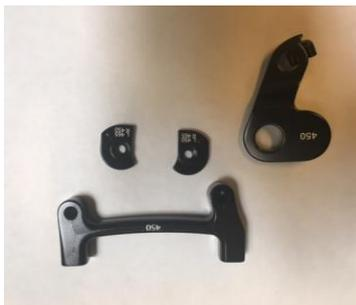
Für den Einbau des 27,5" Laufrades sind demzufolge die folgenden Teile vorzubereiten: Flip-Chip 450mm, Schaltauge 450mm und Bremsadapter mit Beschriftung 450mm vorne sichtbar.
