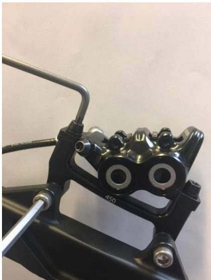
Als Werkzeug benötigst du einen Inbus 5 mm für den Bremsadapter und einen Torx 25 für die Magura-Bremse.
