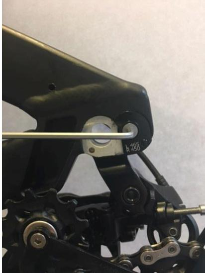
Ebenso verhält es sich mit den beiden Flip-Chips auf der gegenüberliegenden Seite. Linkes der Einbau für das Laufrad 27,5" und rechts für das Laufrad 29".
