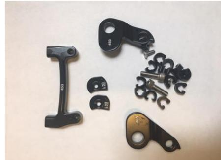
Ebenfalls ist der Bremsadapter gekennzeichnet mit 450mm. Wenn diese Seite sichtbar ist, dann ist die Bremse für den Einbau des 27,5" Laufrades angepasst. Ist die nicht gekennzeichnete Seite des Bremsadapters sichtbar, so ist die Bremse für das 29" Laufrad ausgerichtet.
