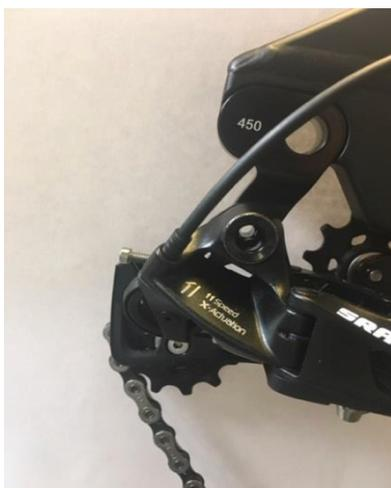
Auf dem linken Bild sieht man die Position des Schaltauges für den Einbau des 27,5" Laufrades mit 450mm und auf dem rechten Bild die Position des Schaltauges für den Einbau des 29" Laufrades mit 465mm
