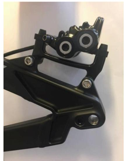
Gegebenenfalls muss die Bremse nach dem Umbau noch etwas justiert werden.
