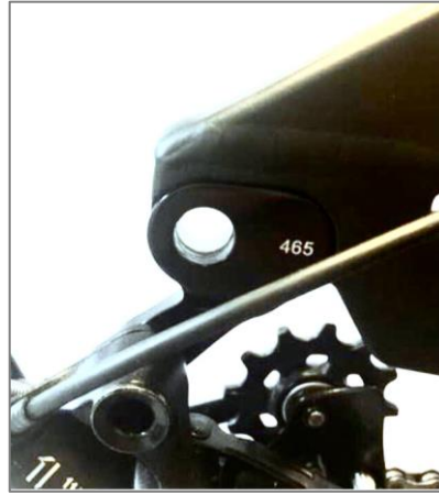
Position Schaltaupe für Laufrad 29"
