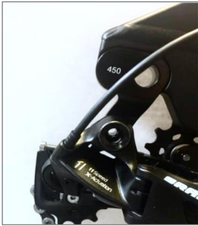
Position Schaltaupe für Laufrad 27,5"
